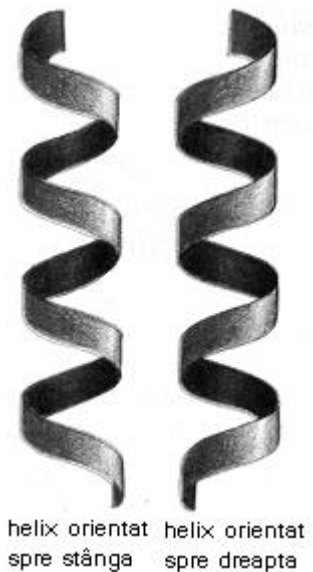
Figura 2-11 Comparare dintre un helix orientat spre dreapta și unul orientat spre stânga. Ca referință se consideră că orientarea standard spre dreapta este în sensul acelor de ceasornic.
