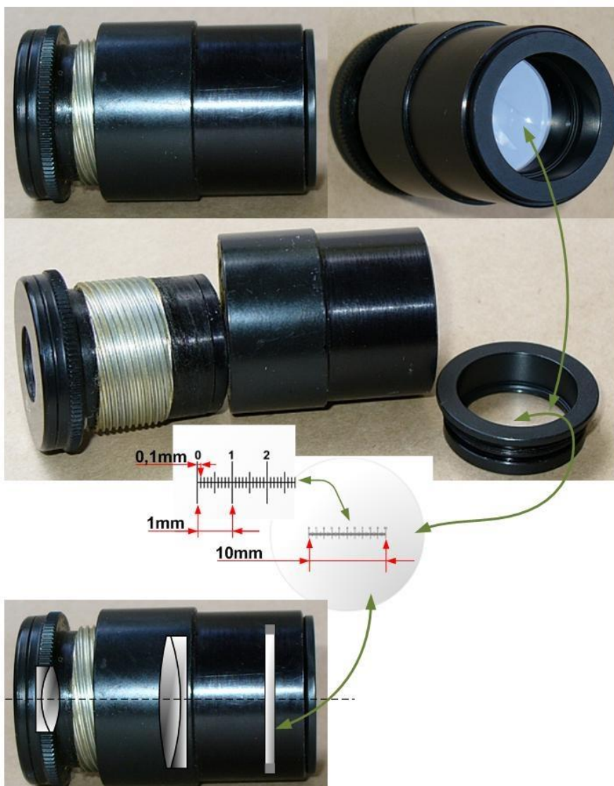
Figura 2.15. Etalonarea micrometrului ocular (sursa Creative Commons)
